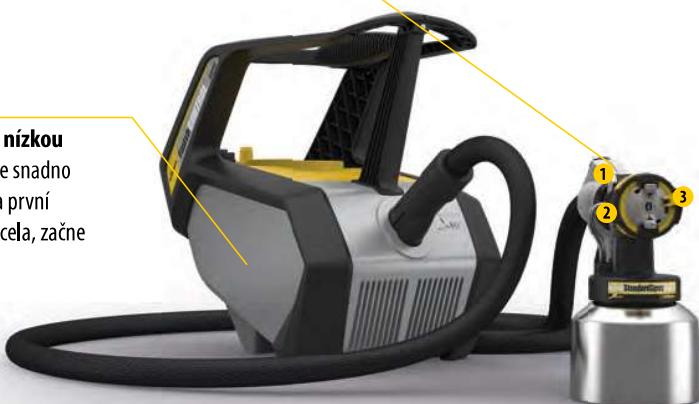
**Direct Spray Control:** FinishControl se snadno ovládá. (1) Plynule nastavitelný objem vzduchu a (2) regulace objemu materiálu zajišťují přesné přizpůsobené množství materiálu. (3) Úroveň stříkání a šířku stříkaného pruhu lze upravit tak, aby vyhovovala stříkanému předmětu
